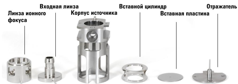
Рис. 29 Компоненты ионного источника ХИ, которые нужно очистить
