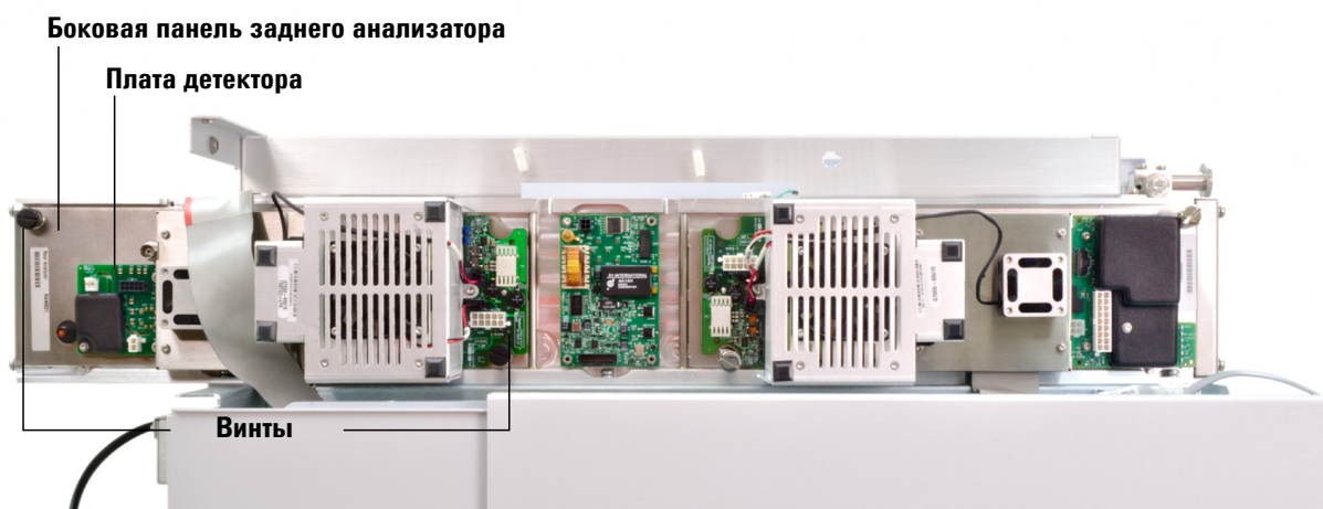
Камера закрыта (для удобства кабели сняты)
